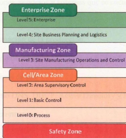
Ilustración 4: Purdue Model for Control Hierarchy logical framework. [Modelo Purdue para un modelo lógico jerárquico de control] Obregon, 2015.
